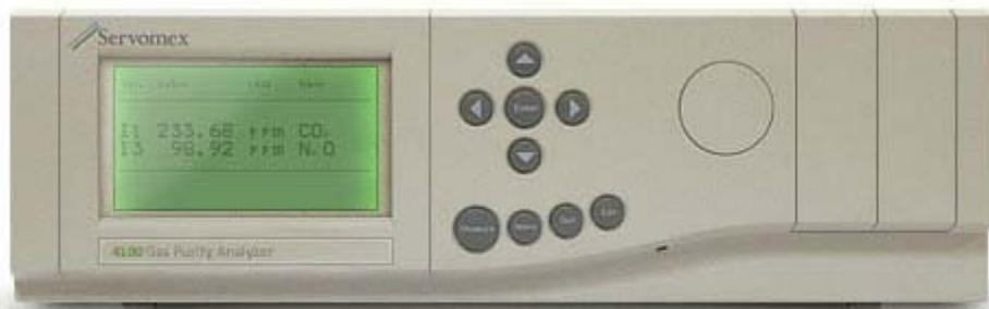
Анализатор предназначен для непрерывного контроля технологических процессов, связанных с разделением воздуха. В зависимости от конфигурации, определяет в газовой пробе:
