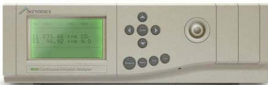
Анализатор предназначен для непрерывного мониторинга выбросов промышленных предприятий. В зависимости
