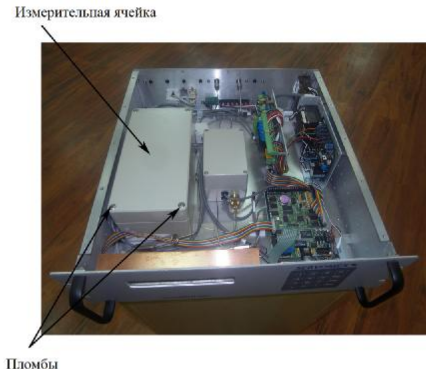
Рисунок 2 – Место пломбирования измерительной ячейки
